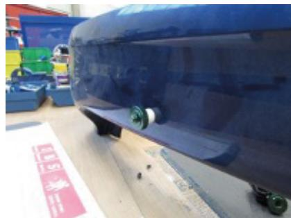
Tragen Sie bitte an den vorgesehenen Stellen des Halters eine ausreichende Menge an Klebemasse auf. Anschließend positionieren Sie den Halter wie auf den Fotos zu sehen. Die dauerhafte Fixierung geschieht durch den schwarzen Spannbügel und einer Rändelmutter.
