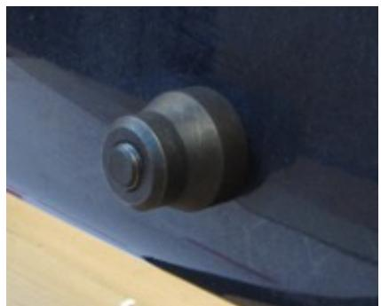
Drehen Sie die Schraube mit einem entsprechenden Werkzeug und achten Sie darauf, dass sich das Gegenstück der Lochstanze auf der Außenseite nicht mit dreht.
