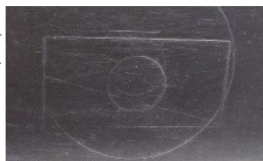
Bohren Sie zuerst in der Mitte des Kreises ein Loch. Die Bohrung erfolgt immer von innen nach außen.
