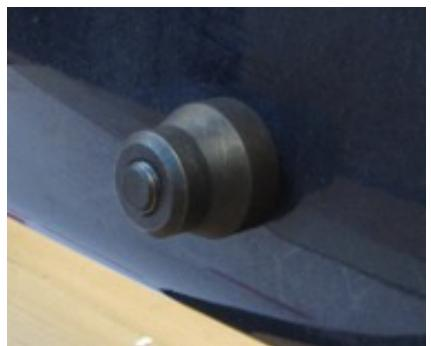
Faites tourner la vis avec un outil adapté et veillez à ce que la contrepartie de la poinçonneuse ne tourne pas avec de l'autre côté (extérieur).
